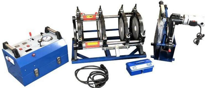
**Гидравлический стыковой сварочный аппарат SUD 50-250H PRO.** Предназначен для монтажа труб из полиэтилена (высокого и низкого давления) и полипропилена.
